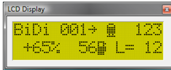
Abbildung 20: BiDi Ansicht 2 (Lok Adresse, Fahrstufe, Treibstoff, Standort)
